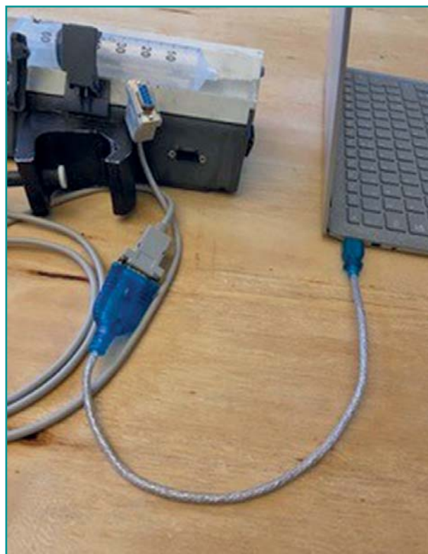
Figura 2 - Dettaglio sul cavo RS232 con adattatore RS232/usb.
